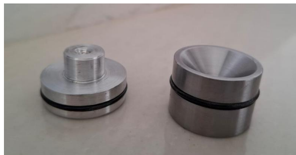
Fig. 2 — Tampão e tubeira com anéis de vedação montados
