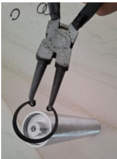
Fig. 6 — Uso do alicate para montagem do anel de retenção
